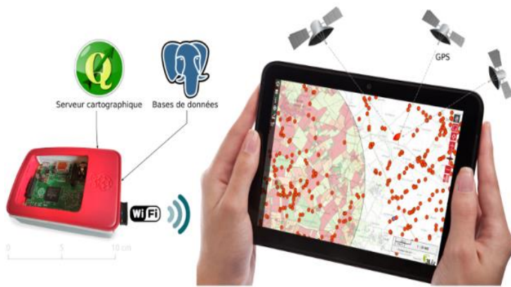
Figure n°16 : Schéma représentant le fonctionnement de Geo Poppy (données Julien Anslin)
