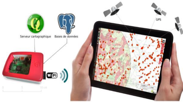
Figure n°16 : Schéma représentant le fonctionnement de Geo Poppy (données Julien Anslin)
