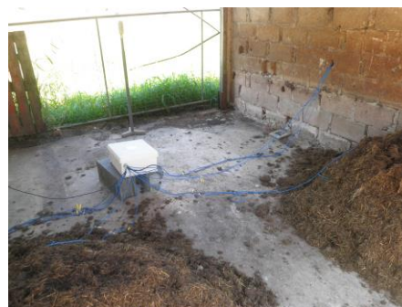
Photo 9 : Mesure de la température de la masse de compost (expérimentation INRA). Crédit photo J. Sierra.
