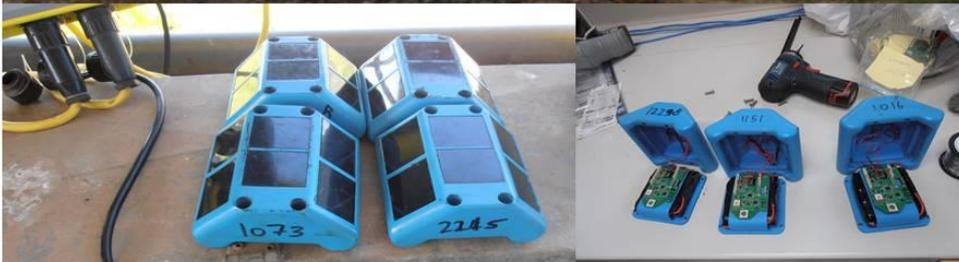
Détails des **colliers utilisés** composés par GPS, magnétomètres et accéléromètres. Des batteries à très basse fréquence sont couplées pour permettre une longue durabilité dans le terrain sans intervention. De mini-panneau solaires sont également situés au-dessus (dans les trois angles de la couverture)
