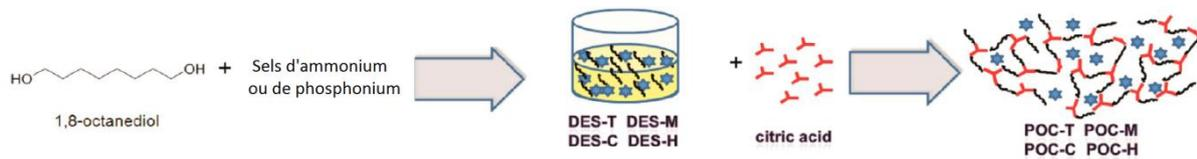
**Figure 4 : Synthèse de polymères bioactifs à base de sels d'ammonium ou de phosphonium (ChCl, tetraethylammonium bromide, hexadecyltrimethylammonium bromide ou methyltriphenylphosphonium bromide, adaptée de García-Argüelles 2013**
