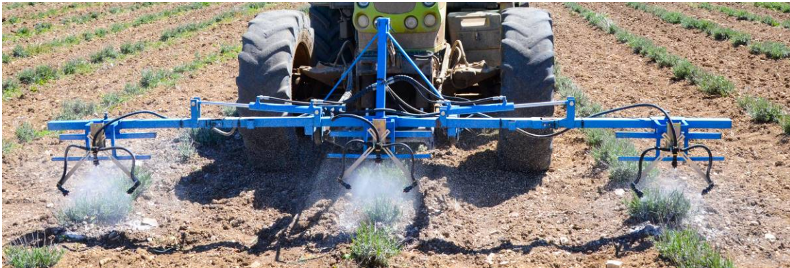
Photo 2 : Kit de pulvérisation testé et mis au point pour assurer une bonne qualité de pulvérisation d'argile
