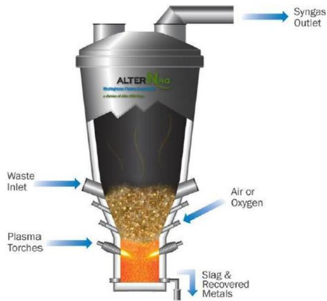
**Figure 14.** Technologies de gazéification plasma Westinghouse (Données Alter NRG)
