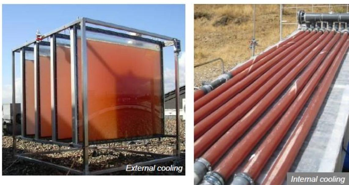
**Figure 36.** Photobioprocédés à l'échelle pilote de photofermentation installés pour la production d'H<sub>2</sub> dans le cadre du programme Hyvolution, soit en panneau (4x25L) à Aachen, Allemagne ou tubulaire (80L) à Ankara, Turquie [77]
