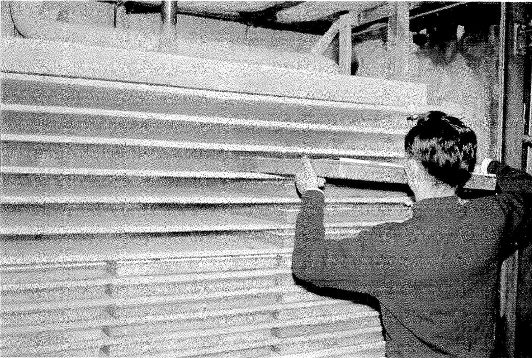
**Photo 5 :** *Introduction des plateaux sur les étagères de l'appareil à congélation. On évite ainsi l'empilement, ce qui permet d'obtenir une congélation rapide.*
