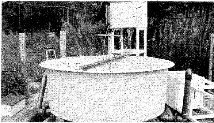
Fig. 2 Prototype d'un bassin circulaire (avec arrivée d'eau centrale et évacuation latérale par trop plein extérieur) expérimenté au centre de recherches de Pitlochry (Ecosse).
