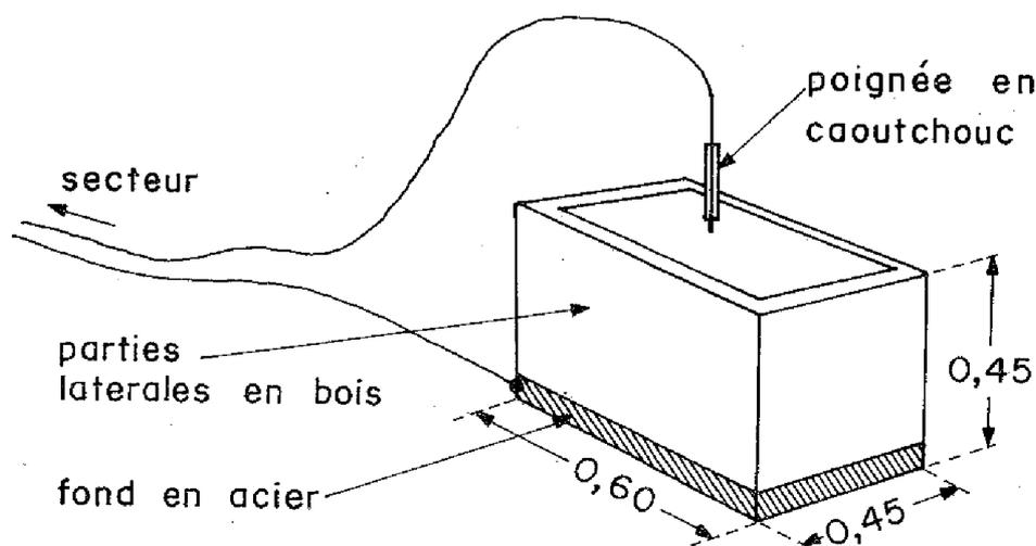
FIG. 2. — Schéma d'une « chambre d'électrocution » pour Poisson
