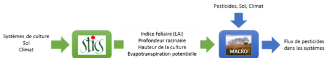
Figure 1. Représentation schématique du forçage du modèle MACRO par le modèle STICS
