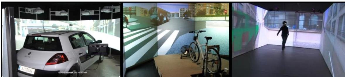
Figure 2 : Trois exemples de simulateurs de déplacement présents à l'IFSTTAR. De gauche à droite : un simulateur de voiture, un simulateur de vélo et un simulateur de traversée de rue pour piétons.
