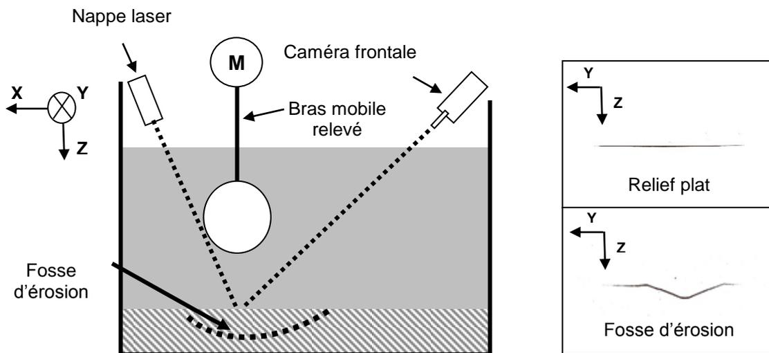
Figure 2. Schéma du dispositif de suivi par la méthode optique.
