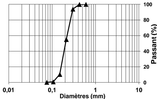
Figure 4. Courbe granulométrique du sable de Fontainebleau.
