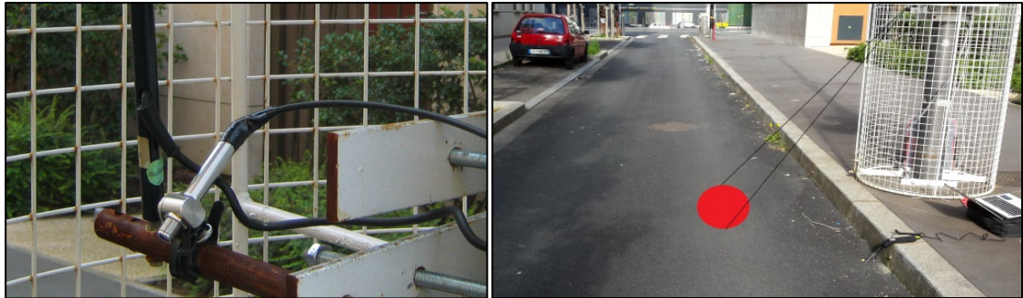
Figure 5 : Pyromètre IR et spot de mesure (2014, Veolia)
