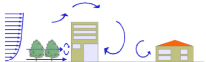
Phénomènes aérodynamiques, échanges convectifs, transport de chaleur
