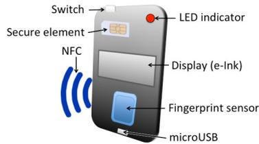
Figure 1: Schéma des composants OffPAD v.1
