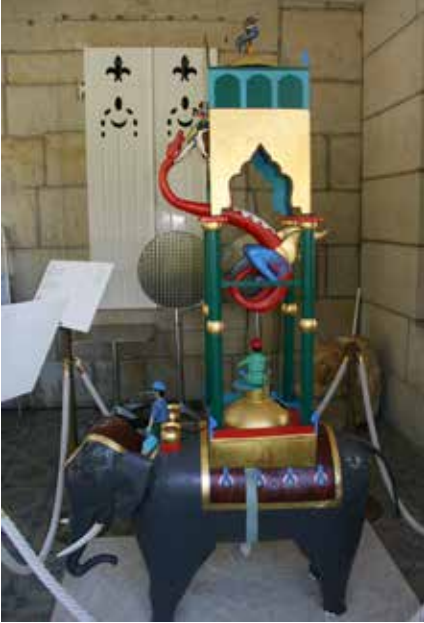
Fig. 4 – Reconstitution de la clepsydre à l'éléphant d'al-Jazarî (Musée d'horlogerie du Locle, Suisse; cliché J.-P. Willa)
