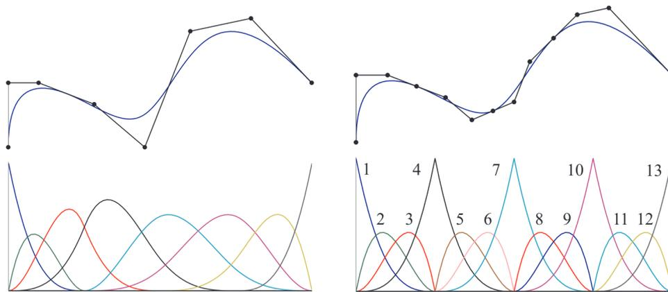
FIGURE 2 – D'une géométrie B-Spline (à gauche) à une géométrie Bézier (à droite) [7]
