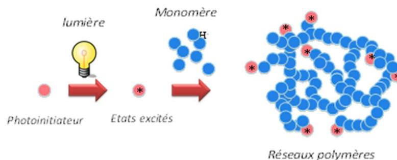
Figure 1: Schéma de principe du processus de photopolymérisation.
