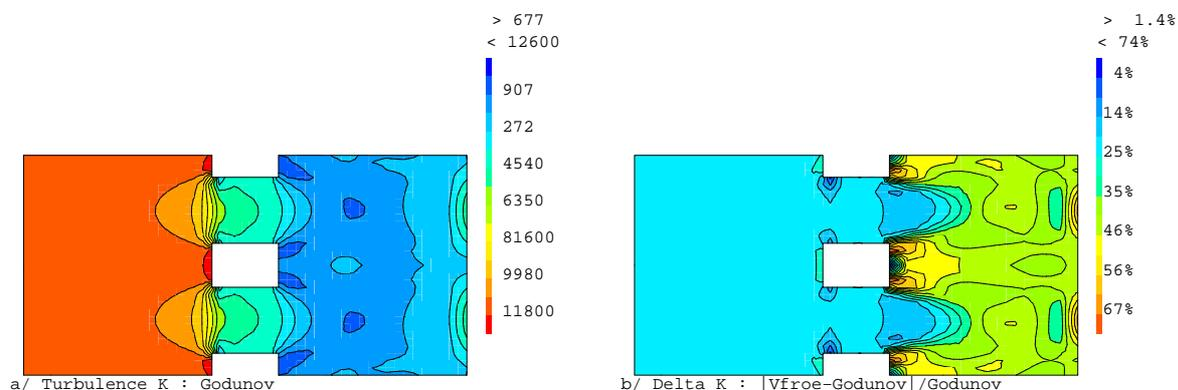
FIG. 1 – a) K par le schéma de Godunov b) Écart sur K entre Vfroevnev et Godunov
