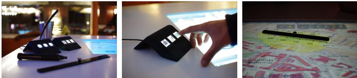
Figure 26. Solutions tangibles connectées à la table interactive d'INDIGO (stylo, règle, et boutons)
