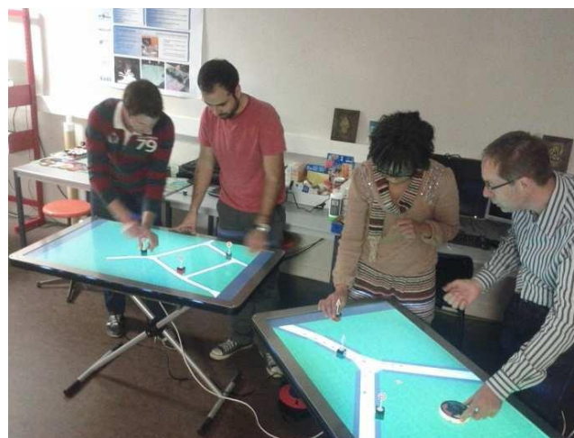
Figure 20. Deux tables interactives de type TangiSense v2 connectées utilisées dans un contexte collaboratif distribué impliquant des objets tangibles et virtuels : simulation de trafic routier (Kolski et al., 2013).
