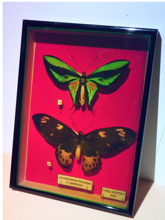
Figure 4 - Hologramme couleurs d’une boîte de papillons ( Ornithoptera paradisea ), enregistré dans une émulsion argentique et restitué en lumière blanche. L’observateur a l’illusion d’avoir devant lui la boîte-objet, alors qu’il s’agit d’une image holographique. (Par courtoisie d’Y. Gentet [5]).
