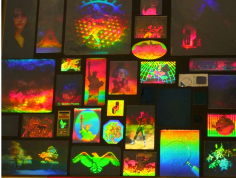
Figure 5 – Collection d’hologrammes créés par estampillage, l’hologramme maître étant enregistré dans un photoresist. Ils sont utilisés à des fins publicitaires, en tant que systèmes anti-contrefaçon ou permettent d’introduire des illustrations en 3 dimensions dans les magazines (Collection C. Carré).
