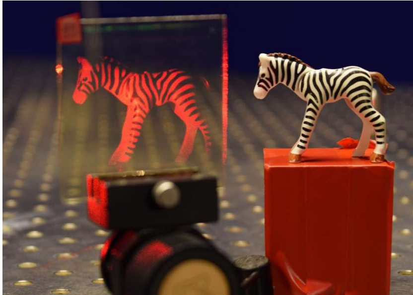
Figure 3 – Exemple d’hologramme monochrome: restitution de l’image holographique et objet correspondant. Enregistrement effectué à l’ENSSAT à Lannion, en transmission à 633 nm. Le support photosensible est ici une émulsion argentique commercialisée par la société Ultimate Holography (plaque U08 70). (Photo réalisée par Yoann Atlas, élève ingénieur optronique de l’ENSSAT, et Laurent Feichter).
