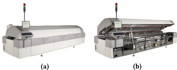
Figure 2 : Four à souder (a) fermé (b) ouvert.
