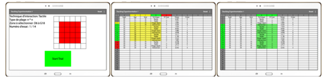
Figure 8 : Ecran principal de l'application (gauche), exemple de sélection (milieu) et validation automatique (droite). Au cours d'une sélection, la plage de donnée sélectionnée est affichée en jaune, une fois validée, la sélection est affichée en vert. Les intitulés de lignes/colonnes sont affichés en rouge lorsque leur sélection est nécessaire mais pas encore faite, en jaune lorsque leur sélection n'était pas demandée mais a été faite et en vert si la sélection est valide.
