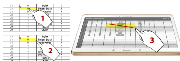
Figure 2 : Sélection d'une plage de cellules avec l'interaction tactile : Tap sur une cellule (1), sélection d'une ancre (2) et drag pour étendre la sélection (3).
