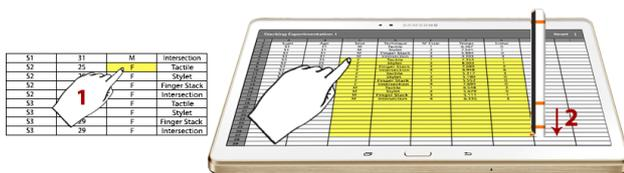
**Figure 7 : Illustration de la technique Finger Stack : tap pour sélectionner le coin haut-gauche (1) puis *stack* pour choisir le coin bas-droit (2).**
