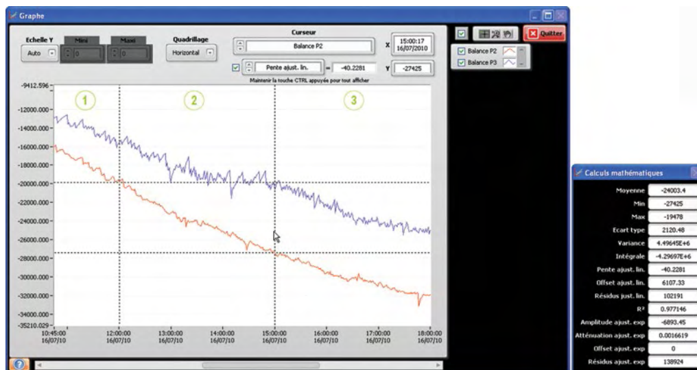
Figure 17. Exemple de calcul des pentes des signaux bruts des balances.
