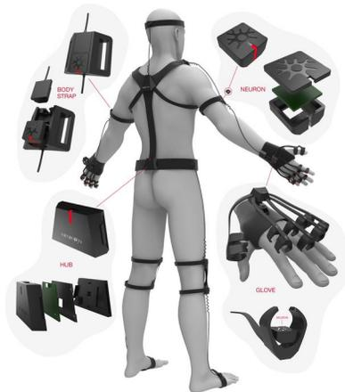
Figure 4 : Réseau de centrales inertielles pour la retranscription en temps réel d'un avatar virtuel reproduisant les mouvements du sujet.
