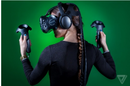
Figure 3 : Système HTC Vive avec manettes pour interaction avec l'environnement virtuel.
