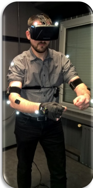
Figure 5 : Sujet partiellement équipé de marqueurs réfléchissants, de centrales inertiels, de capteurs physiologiques et d'un casque de réalité virtuelle.
