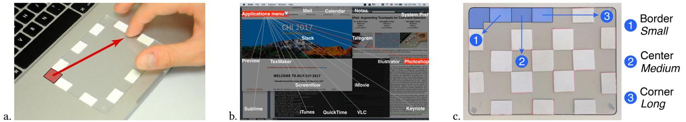
**FIGURE 3: Aperçu du projet MarkPad : (a) geste directionnel couplé à une position de départ et une distance particulière, (b) retour affiché sur l'écran du geste en mode novice, (c) types de gestes utilisés pour évaluer l'efficacité de la technique MarkPad. Le touchpad est augmenté par des marques passives pour aider l'utilisateur dans sa tâche.**
