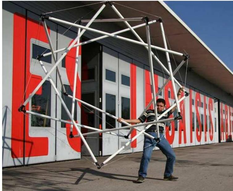
FIG. 7 – Prototype léger de 25 kg soulevé par une personne
