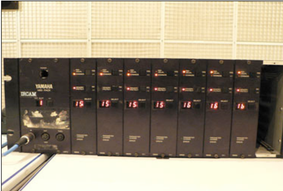
Figure 3. Le synthétiseur d'origine Yamaba TX816 dont une grande partie des modules ne fonctionne plus. Source : Serge Lemouton.
