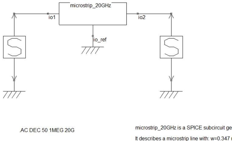
Figure 3- 69: S parameter simulation of microstrip line (\\Examples\\basic\\PCB\\microstrip\_S\_parameters.sch)
