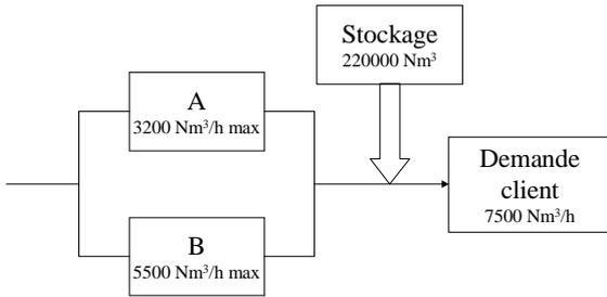
Fig. 1 : Schéma du système de production
