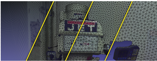
FIGURE 7 – Surface reconstruite à différentes résolutions avec notre méthode à partir du nuage de points de gauche.
