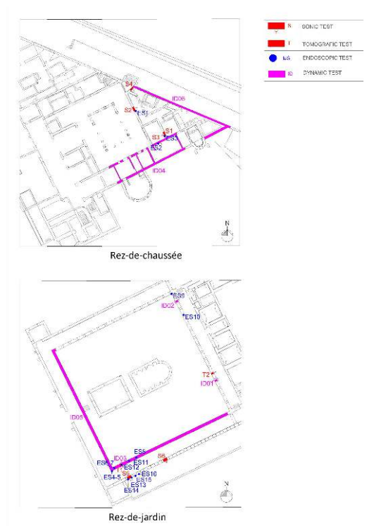
Fig. 12 – Emplacement des tests ingénieriques.
