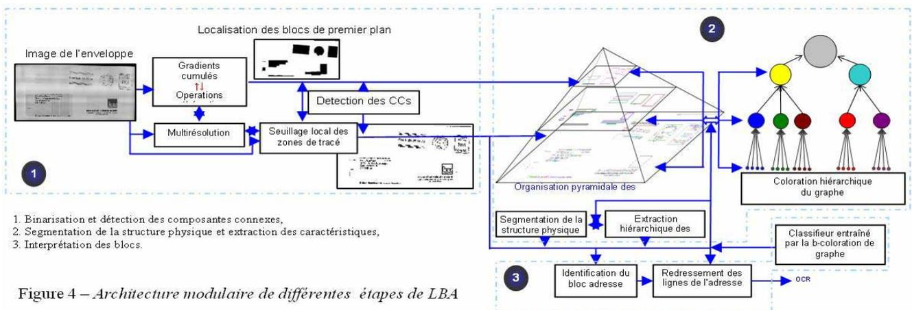
Figure 4 – Architecture modulaire de différentes étapes de LBA
