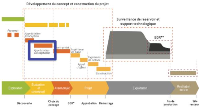
Figure 1: Cycle de vie d'un actif pétrolier
