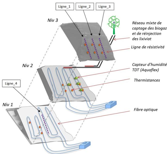
**Fig. 1 - Vue éclatée du casier n°4 avec les capteurs installés sur 3 niveaux (Grossin-Debattista et al., 2014)**
