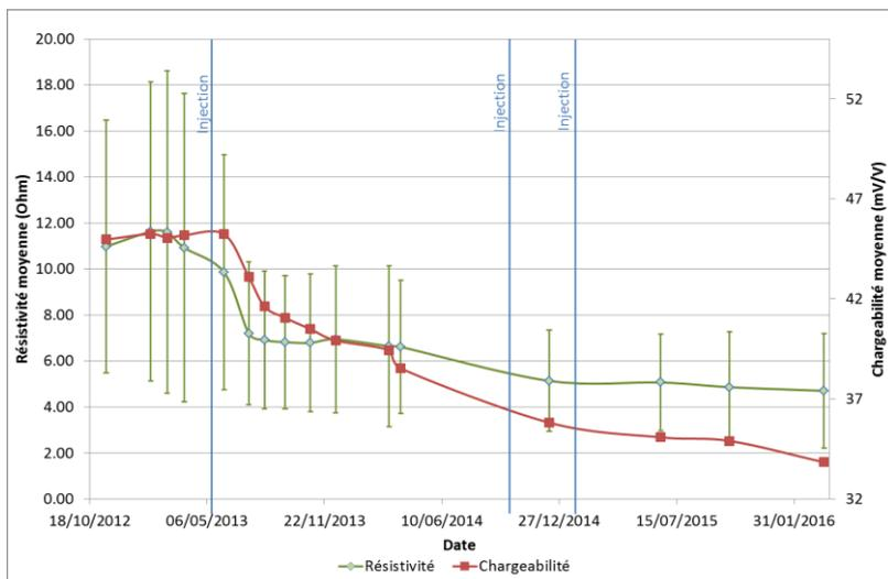
**Fig. 2 – Suivi de la résistivité et de la chargeabilité apparente moyenne du casier 4**
