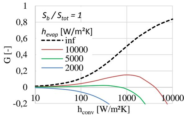
Figure 6 : Evolution du gain d'un diffuseur ( $S_b/S_{tot} = 1$ )
