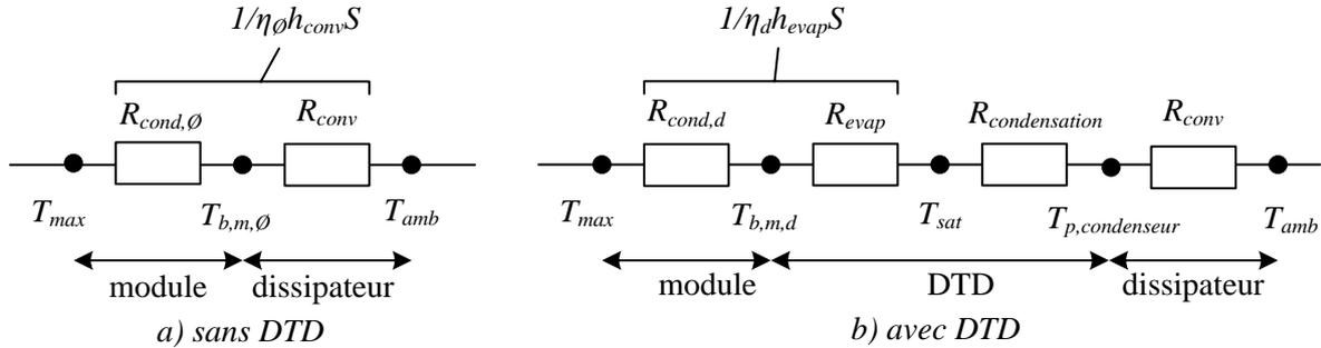
Figure 5 : Schéma de résistances thermiques dans le cas d'un module avec et sans DTD
