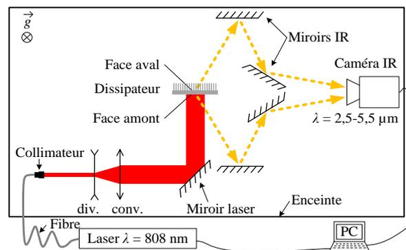
Figure 11 : Schéma de principe du dispositif expérimental (vue de dessus)
