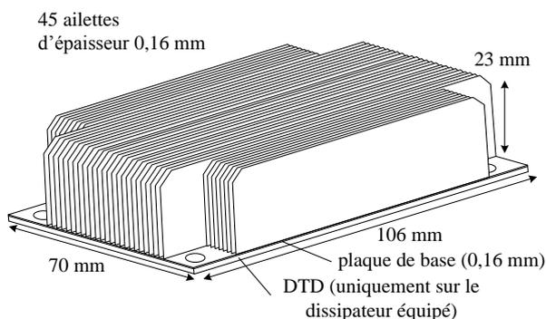
Figure 10 : Dimensions principales des dissipateurs caractérisés
