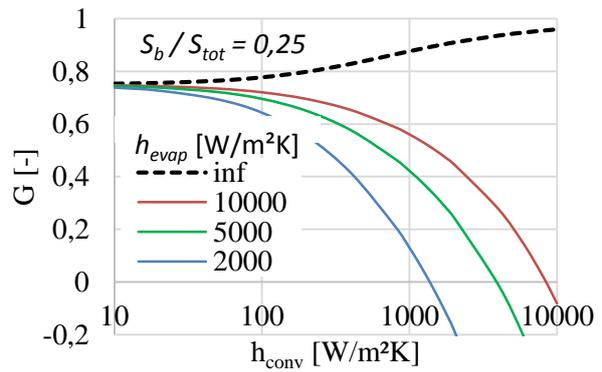
Figure 7 : Evolution du gain d'un diffuseur ( $S_b/S_{tot} = 0,25$ )
