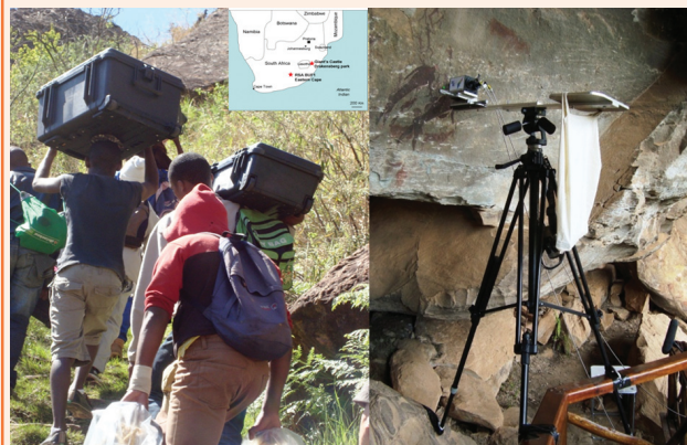
À gauche : transport par porteurs de l'équipement Raman sur un sentier de montagne pour accéder aux peintures rupestres de Giant's Castle en Afrique du Sud [23]. À droite : la tête déportée analyse les pigments d'un théranthrope (personnage fantastique mi-homme mi-animal) ainsi que les couches d'efflorescence se formant sur la peinture. Photos : C. Paris et A. Tournié, DR.
