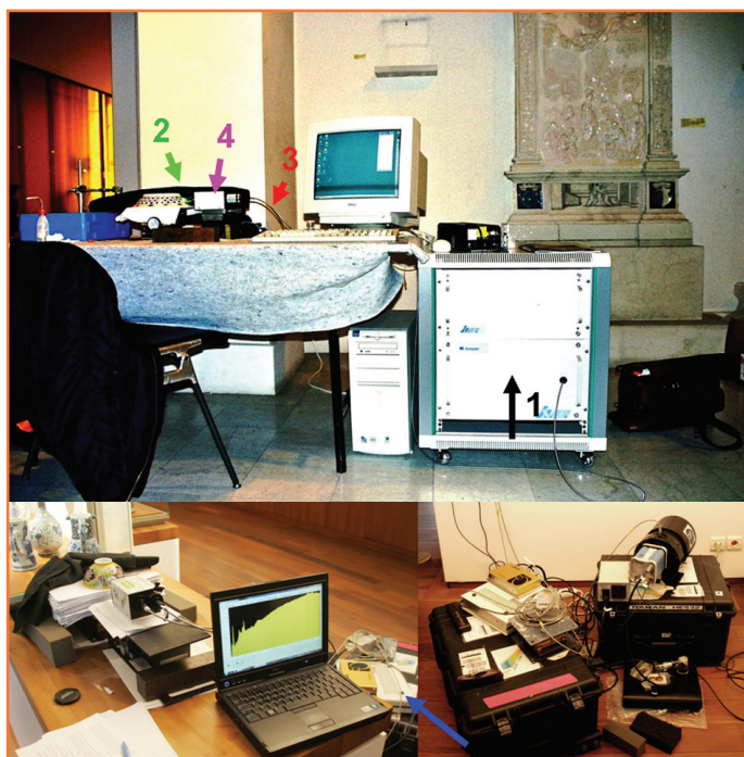
Figure 2 - En haut, premier dispositif mobile (2003, [8]) montrant le rack sur roulette comprenant le spectromètre (1, flèche noire), le laser YAG refroidi par air (2, flèche verte), les fibres optiques (3, flèche rouge) et la tête de mesure déportée analysant une porcelaine de Médicis (4, flèche mauve) au musée national de la Céramique (Cité de la Céramique, Sèvres). En bas, les différents composants (spectromètre, laser et dispositifs électroniques de commande) d'un système de dernière génération à haute détectivité tiennent sur les couvercles des caisses de transport. Noter le spectre (raies « fines » Raman sur le fond croissant de fluorescence) mesuré sur un bol de porcelaine émaillé produit pour un empereur Qing au musée national des arts asiatiques-Guimet ; un tissu noir doit recouvrir l'objet et la tête pendant la mesure pour éviter la « pollution lumineuse » des éclairages et assurer la protection des opérateurs (photos P. Colombar, DR).
