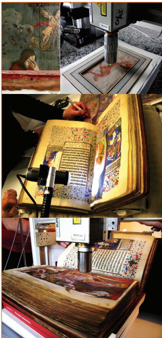
Figure 3 - En haut : coupe d'un microfragment (en haut à gauche) montrant la stratigraphie dans une zone peinte en rouge du tableau du XVI e siècle dont le détail est présenté au-dessus (Coll. privée) [9]. L'utilisation d'objectif de haute qualité à très longue distance de travail, comme ici un objectif x200 à grande ouverture donnant un spot au diamètre inférieur au micron, permet d'analyser un grain de pigment d'un dessin Renaissance (Coll. privée) sans que le spectre soit masqué par la forte fluorescence du support papier [10]. Au milieu et en bas : analyse d'un manuscrit illuminé avec une caméra hyperspectrale (milieu) et par diffusion Raman (bas), Bibliothèque Nationale de France, Paris (photos : P. Colombari, DR).
