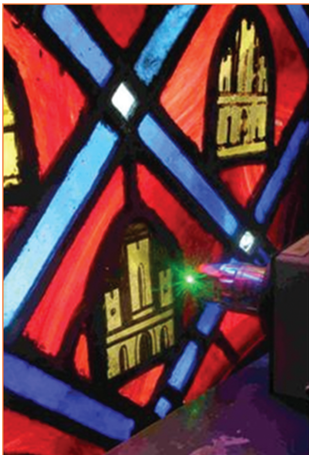
Figure 5 - Détail d'une verrière de la Sainte-Chapelle aux armes de Blanche de Castille en cours d'analyse [13]. La couleur rouge est obtenue par la dispersion de nanoparticules de cuivre, tandis que la couleur jaune vient de la dispersion de nanoparticules d'argent [15-16]. © C. Lebedinsky/CNRS Photothèque.
