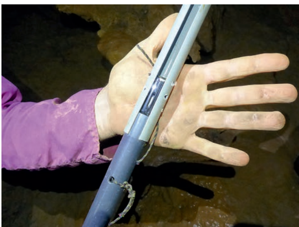
Photo 6 : La sonde CTD dans son tube formant un fourreau de protection, avant installation dans le siphon 1 du Rêgaïe de Néoules le 16/09/2014. Cliché B. Arfib & T. Lamarque. The CTD probe in a pipe for protection, before fixing it on the wall of the sump #1 of the cave "Rêgaïe de Néoules".
