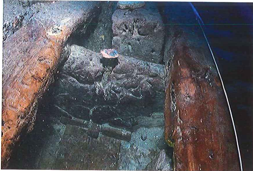
Fig. 12: Vue de la broche sur l'enture entre la quille et le brion d'étambot. Photo: L. Brisciano.
