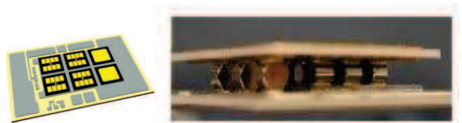
Fig. 4. Vues du prototype NT1 – module de puissance en technologie hybride et Bump bonding(Alstom)
