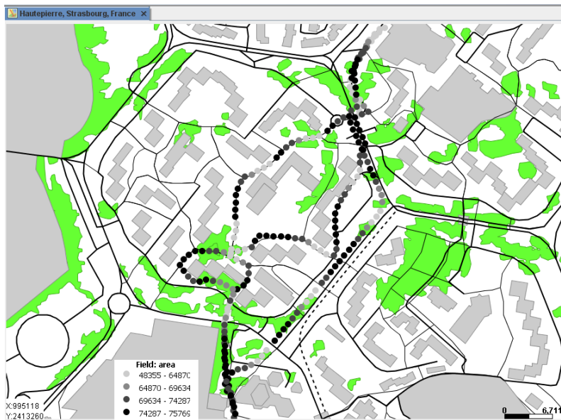
Figure 7. Exemple de discrétisation de trois itinéraires reliant le Centre socio-culturel Le Galet au centre commercial dans le quartier de Hautepierre. La symbologie correspond à une classification par intervalle des aires en m 2 de l’isovist calculé en chaque point considéré.
