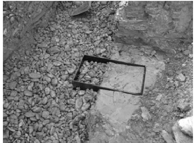
FIGURE 3. PRELEVEMENT D'ECHANTILLON INTACT A L'INTERFACE TRANCHEE/SOL (T2).
