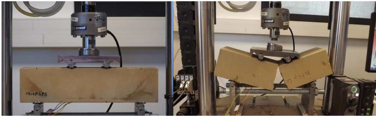
Figure 15 : Dispositif expérimental et mode de rupture attendu des éprouvettes
