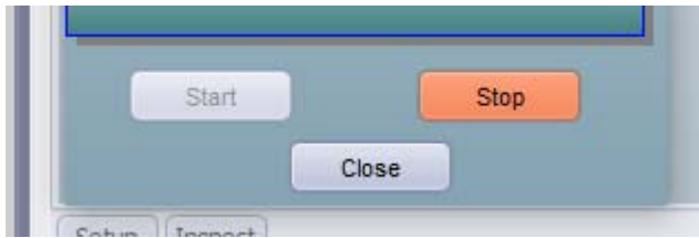
Figure 3.2.e Bouton d'arrêt forcé de la procédure de dégazage
