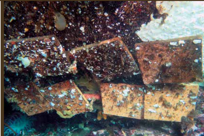
Placettes de colonisation : au moment de l'installation à l'îlot Channer (à gauche) et après un an d'immersion à l'île Longue (à droite). De nombreux organismes (algues, ascidies, éponges, bryozoaires) se sont installés.
