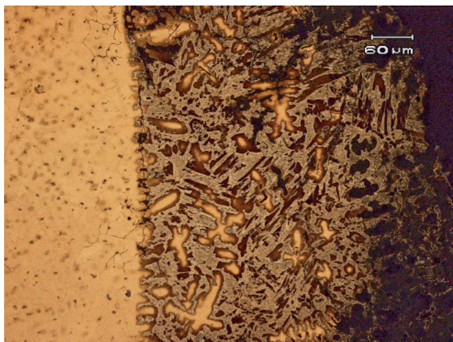
Fig. 2. Micrographie d'une tôle (1000.2.0.1). Interface entre les deux coulées successives.
